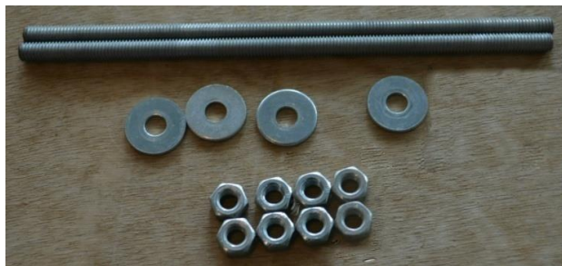
Εικόνα 11: Δύο Σπειροειδείς ράβδοι (ντίζες), 8 παξιμάδια και 4 ροδέλες για την στερέωση των ράβδων πάνω στην ξύλινη βάση
