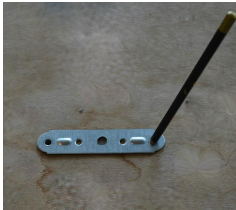
Εικόνα 9: Μεταλλική λάμα πάνω σε ξύλινη βάση. Σημαδεύουμε (ή μαρκάρουμε) τα σημεία των οπών με μολύβι.
