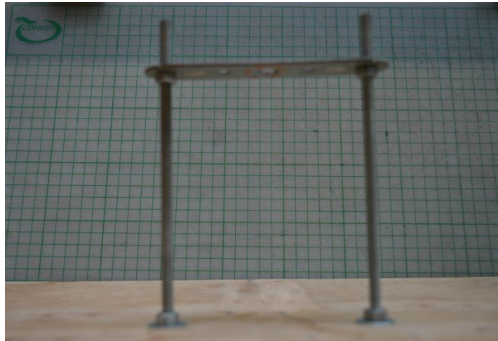
Εικόνα 14: Παξιμάδια και μεταλλική λάμα στερεωμένα στις σπειροειδείς ράβδους.
